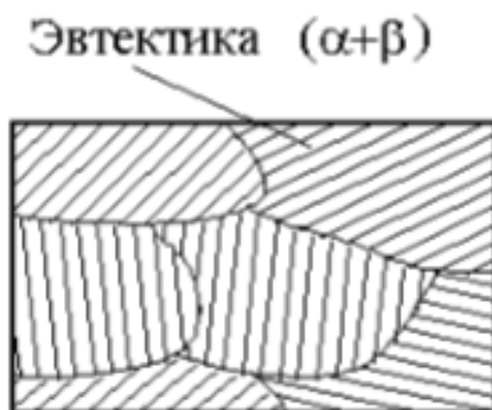
Рисунок 9 – Микроструктура эвтектического сплава (схема)
